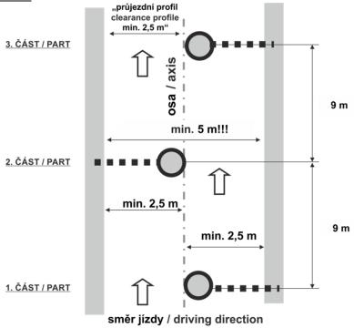
Příklad posunutí prvku ze základny v retardéru. / Example of moving an element of the retarder off the base.
